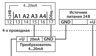
Рис. 18. Схемы подключения преобразователей в унифицированный сигнал 4...20 mA
