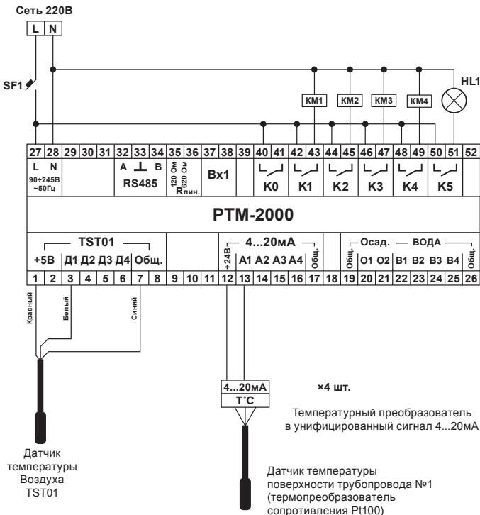
При работе алгоритма «Труба+» вход №1 для датчика температуры TST01 используется для измерения температуры окружающего воздуха
