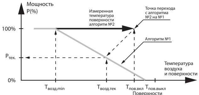
Рис. 12. График вычисления мощности обогрева алгоритма «ТРУБА+».
