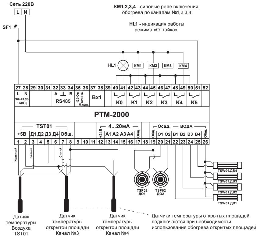
При работе алгоритма «КРОВЛЯ / ДОР» вход №1 для датчика температуры TST01 используется для измерения температуры окружающего воздуха
