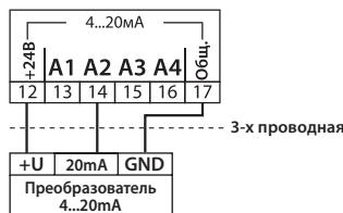
3-х проводная схема включения,
