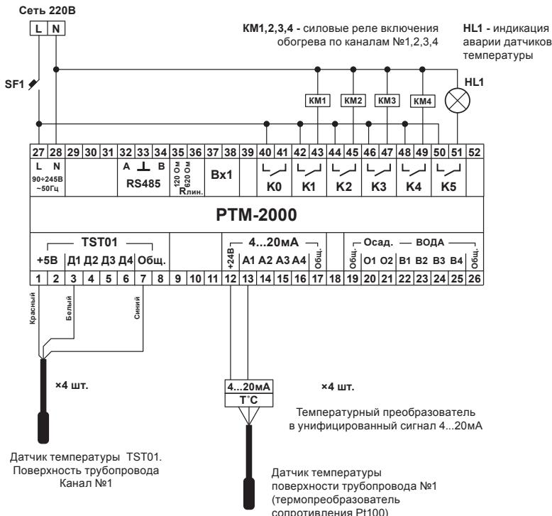
При работе алгоритма «Труба» используются датчики температуры TST01 или датчики с температурным преобразователем в унифицированный сигнал 4..20mA. Приоритетным является вход 4..20mA.
