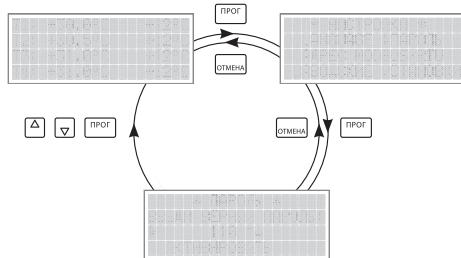
Рис. 9. Установка пароля доступа к настройкам регулятора.
